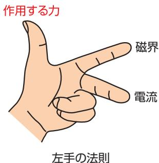
なお、フレミングの法則は左手と右手があるが、これらを混同しないように注意されたい。磁界中に電流を流して、力を作用させる場合は左手。逆に磁界中で力を与えて、発電させる場合は右手である。
